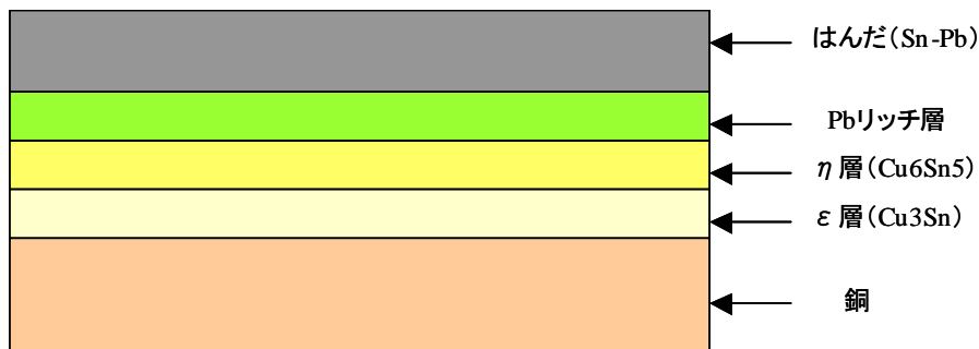
図 1. 共晶はんだと銅の接続イメージ図
