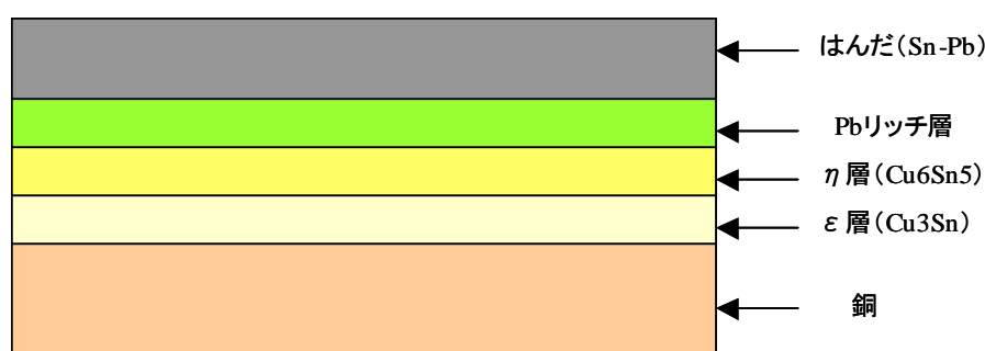
図.11 共晶はんだと銅の接続断面図
