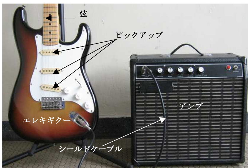
図1. エレキギターとアンプの接続図
