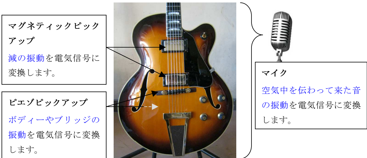
図9. ギターの振動とピックアップの関係
